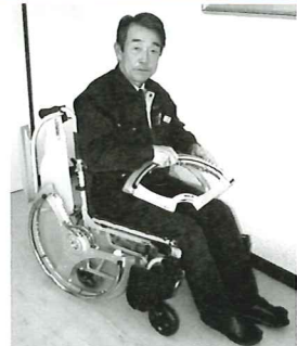
開発者の木川社長と『輪助』。車輪を外した状態での転倒を防止する安全装置が付けられ、安全・快適に使用できます
